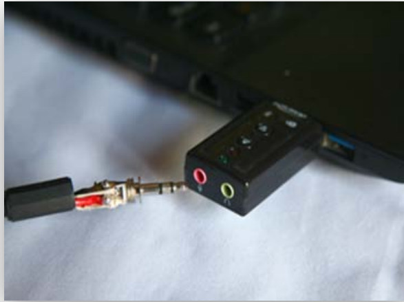
Εικόνα 2. Τα καλώδια από τα ελεύθερα άκρα των δύο πηνίων έχουν συγκολληθεί σε ακροδέκτη τύπου Jack. Ο ακροδέκτης θα τοποθετηθεί στην είσοδο για μικρόφωνο του υπολογιστή. (Φωτογραφία Τ. Λάζος)
