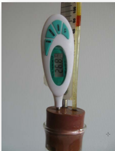
Εικόνα 1. Τοποθέτηση θερμόμετρου και σωλήνα στο πώμα της φιάλης. (Φωτογραφία του συγγραφέα)
